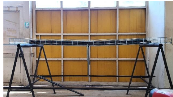
Foto N°7: Muestra con toda la carga aplicada, sin colapso
