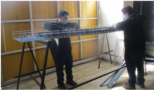
Foto N°6: Aplicación de carga distribuida
