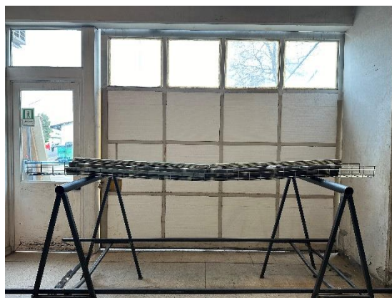
Foto N°5: Muestra con toda la carga aplicada, sin colapso
