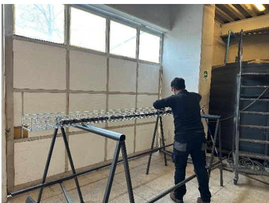
Foto N°4: Aplicación de carga distribuida
