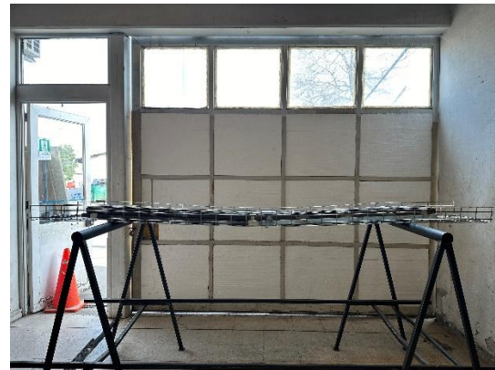
Foto N°4: Muestra con toda la carga aplicada, sin colapso
