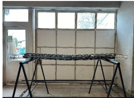
Foto N°5: Muestra con toda la carga aplicada, sin colapso
