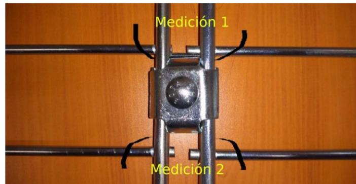
Foto N°7: Medición en conector de 35x35 mm
