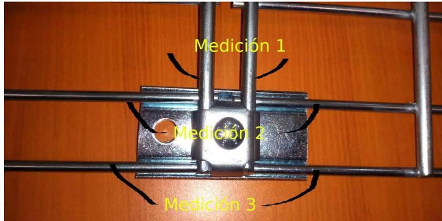
Foto N°8: Medición en conector de 44x80 mm
