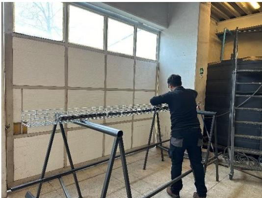
Foto N°4: Aplicación de carga distribuida
