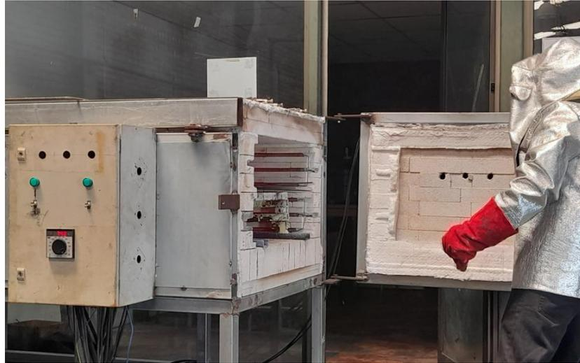
**Fotografía 3:** Probeta P2 al interior del horno durante el inicio de la prueba.
