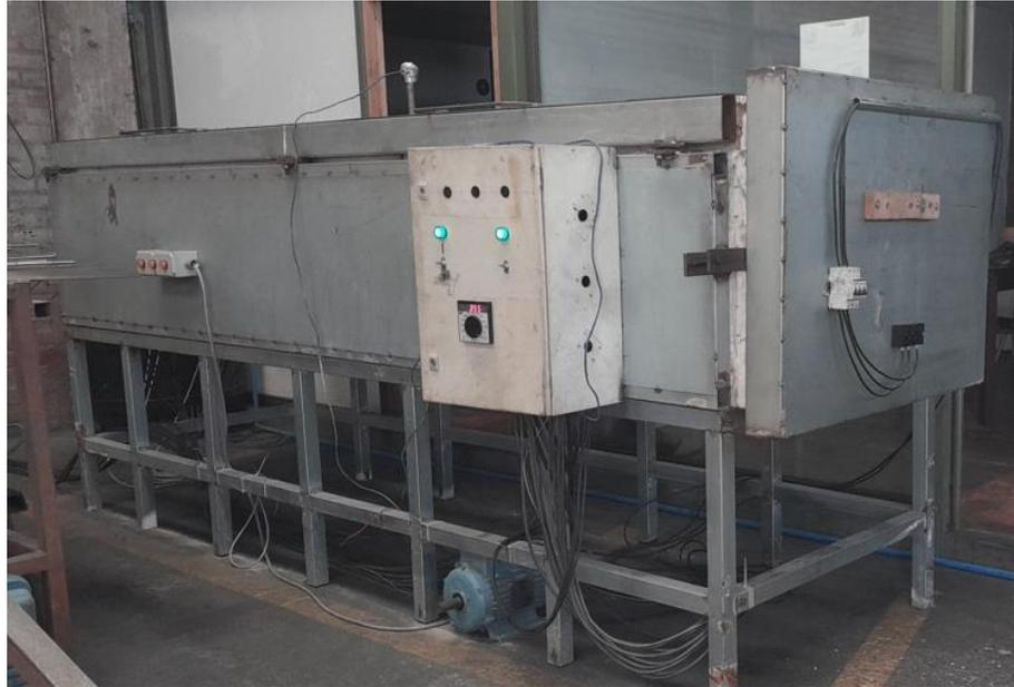
**Fotografía 1:** Horno de ensayos utilizado (Propiedad del mandante).
