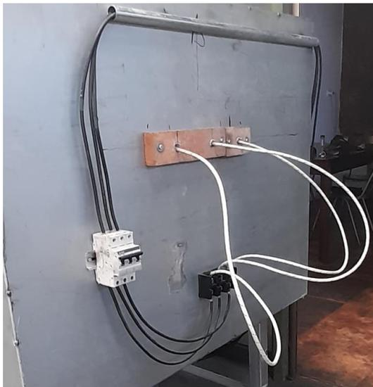
**Fotografía 4:** Conexión del sistema eléctrico, vista frontal del horno, durante el ensayo.
